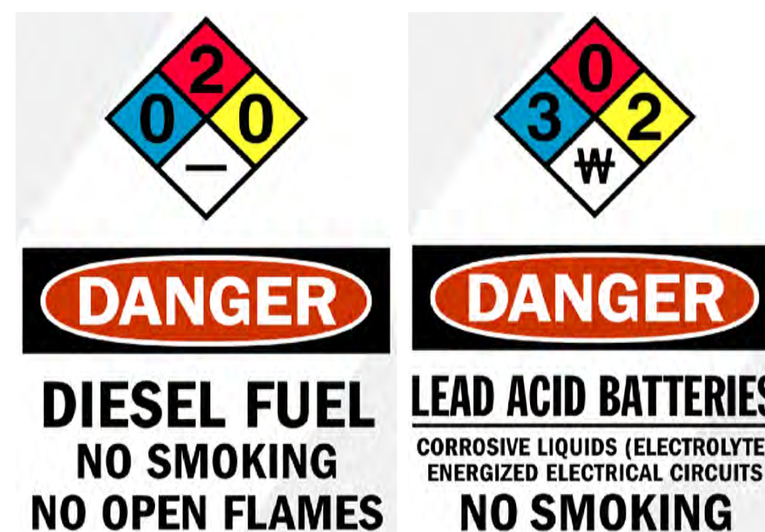
7 NFPA HAZARD SIGN - TYPICAL N.T.S.
